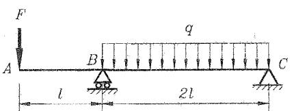
九 (18分) 平面刚架ABC受力如图所示, 刚架各段的  $EI$  相同且为常数。试求A、C端的约束反力(不计剪力与轴力对变形的影响)。
